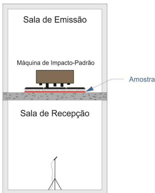
Figura 2 - Salas de avaliação do ruído de impacto do Laboratório de Acústica
